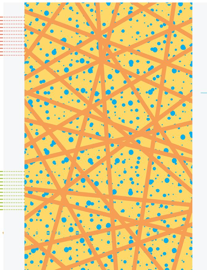
**l'intreccio di fibre trattiene aria che costituisce l'elemento di isolamento termico e acustico.**
